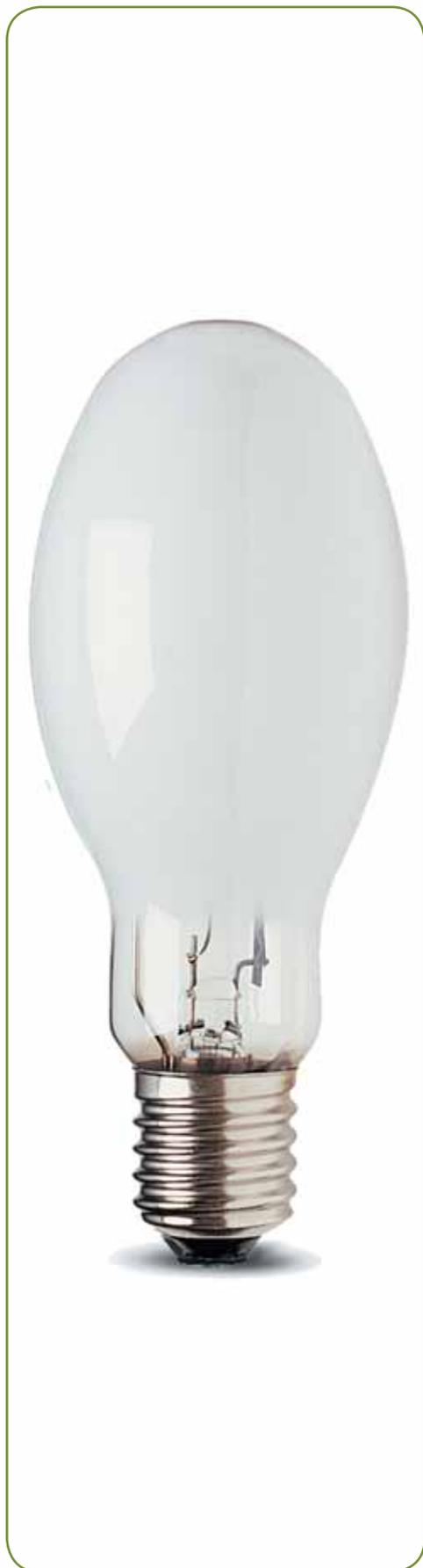
Ртутная лампа (ДРЛ) – разрядный источник света. Разряд паров ртути в горелке дает ультрафиолетовое излучение, которое в слое люминофора нанесенного на внутреннюю стенку колбы преобразуется в видимый свет. Свет ламп ДРЛ имеет синевато-зеленый оттенок и поэтому они хорошо подходят для освещения зеленых зон – скверов, парков, аллей.
