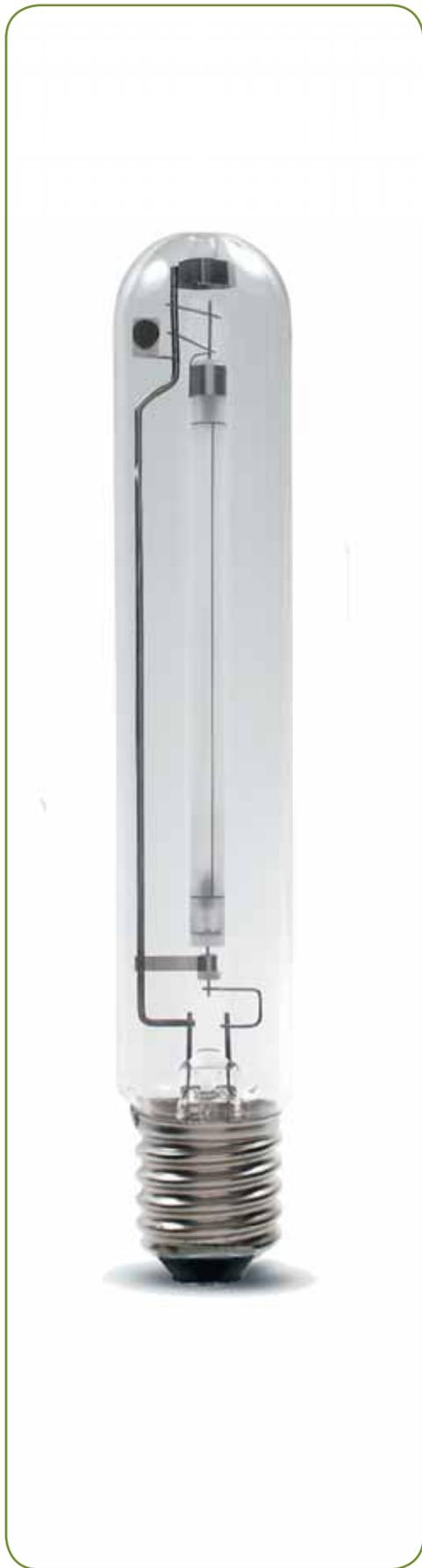
Натриевая лампа высокого давления (ДНаТ) – разрядный источник света. Принцип действия заключается в преобразовании энергии газового разряда в смеси паров натрия и ртути в видимое излучение.
