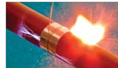
Определение электрической прочности
