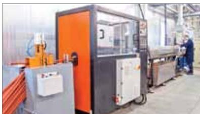
Линии для экструдирования термоусаживаемой трубки
