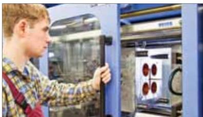
Термопластавтоматы для производства литых изделий
