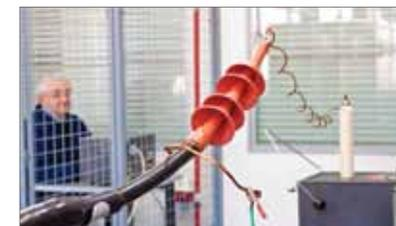
Высоковольтные испытания муфт
